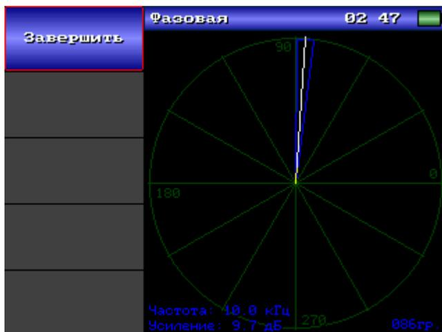
Рис.В. 6 Снятие зоны фрикционных шумов.
