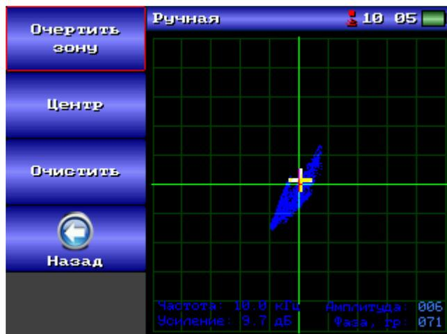
Рис.В. 3 Получение зоны фрикционных шумов.
