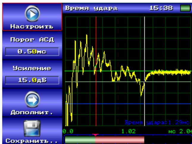
Рисунок D. 8 Ударные колебания на дефектном участке меры дефектов TS-2.
